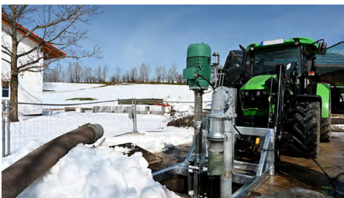
PRESSURA LW - Avec châssis levage dans fosse lisier
